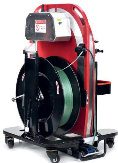
Flexy Strap T550 è un lanciareggia automatico carrellato con alimentazione a batteria, ideale per reggiare bancali in modo rapido e intuitivo. Grazie alla sua struttura compatta e alla grande manovrabilità, si posiziona facilmente accanto al carico da reggiare, ottimizzando tempi e operazioni in magazzino.
