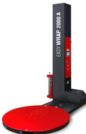
L'avvolgipallet **Easy Wrap 2000 A** è una macchina semiautomatica per l'avvolgimento di carichi pallettizzati con film estensibile. Il tensionamento del film avviene tramite una frizione meccanica (posizionata sul carrello porta bobina) regolabile manualmente dall'operatore.
